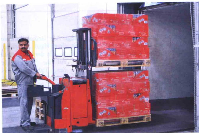
Elektro-Hochhubwagen L 12 LP transportieren gleichzeitig zwei Paletten übereinander und verladen doppelt schnell
