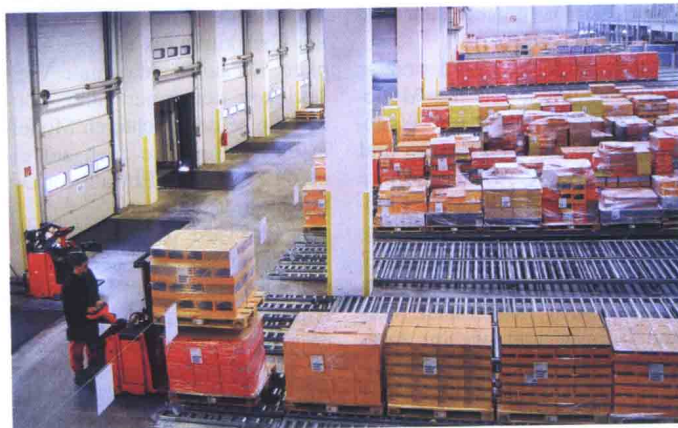
Über Schwerkraft-Rollenbahnen werden die Paletten an die Doppelstockbelader L 12 LP zur Lkw-Beladung übergeben
